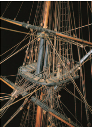
► Mêmes remarques que précédemment pour la grande hune. Au départ de l'araignée, voyez les deux poulies doubles pour les bras de la vergue de misaine et ceux de la vergue de petit hunier.
