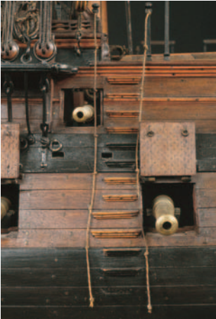
▲ L'échelle hors le bord est formée de taquets moulurés formant degré. Deux chandeliers en fer comportent un cordage dit tire-veille dont les nœuds facilitent l'utilisation.
