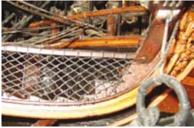
Garnitures de la grande herpe. Elles épousent sur l'arrière le siège d'aisance et la courbe du bossoir.
