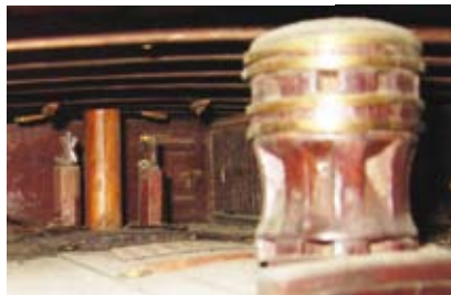
Même vue, prise de tribord. En premier plan, la cloche supérieure du grand cabestan avec son traversin de linguet sur l'avant. Au devant de la cloison de la grande chambre, le mât d'artimon est entouré de deux pompes royales et quatre galoches sont fixées sous les barrots du gaillard pour la drosse de l'axiomètre. La cloison latérale de la boucherie est visible sur bâbord. Il manque la volée supérieure de la grande échelle.
