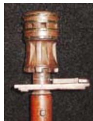
Petit cabestan, avec l'étambrai, les linguets et le traversin. La mèche présente en partie inférieure une surépaisseur et un tenon de section carrée destinés à tourner quelques manœuvres.
