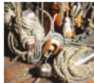
Gros plan sur la poulie de guinderesse du petit mât de hune. Son estrope se fixe autour d'un traversin placé sous le pont du gaillard.
