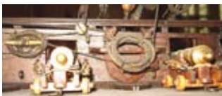
Suite arrière du gaillard. Au milieu, le taquet à oreilles pour l'écoute de la grand-voile. Sur la gauche, le taquet à cornes pour les drisses du grand hunier, du grand perroquet et pour les écoutes des voiles d'étai.
