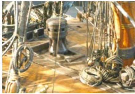
Petit cabestan, avec l'étambrai, les linguets et le traversin. La mèche présente en partie inférieure une surépaisseur et un tenon de section carrée destinés à tourner quelques manœuvres.
