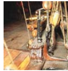
Dernier chandelier du gaillard avant, à la forme particulière. Il reçoit sur son extérieur le premier élément du garde-corps du passavant. À remarquer la dissymétrie du pied, avec l'absence de relief sur l'intérieur.
