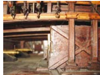
Entrée bâbord du gaillard avant. De chaque côté des cuisines, le pont est protégé par un bordé recouvert d'une feuille en fer blanc. Sur la mouluration du fronteau, sont fichés quatre boucles pour les cargues-fond et cargues-boulines de la grand-voile. À noter les affûts cachés par les ponts, réduits à leur plus simple expression. Étonnant, vu la qualité du modèle.
