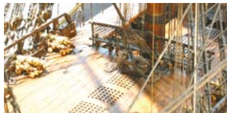
Vue 3 / 4 arrière du gaillard arrière. L'étai du mât d'artimon se termine par une poulie pour sa ride. Cette dernière, au dormant à bâbord, est elle-même ridée par deux caps de mouton sur tribord.
