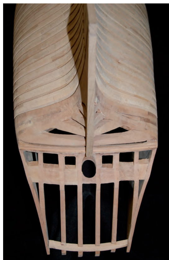
Foto 30 - Particolare dell' specchio di poppa quasi terminato.
