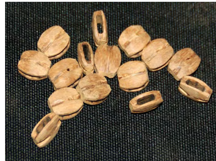
Foto n° 204 - Bozzelli a una gola rifiniti, pronti a ricevere le pulegge.
