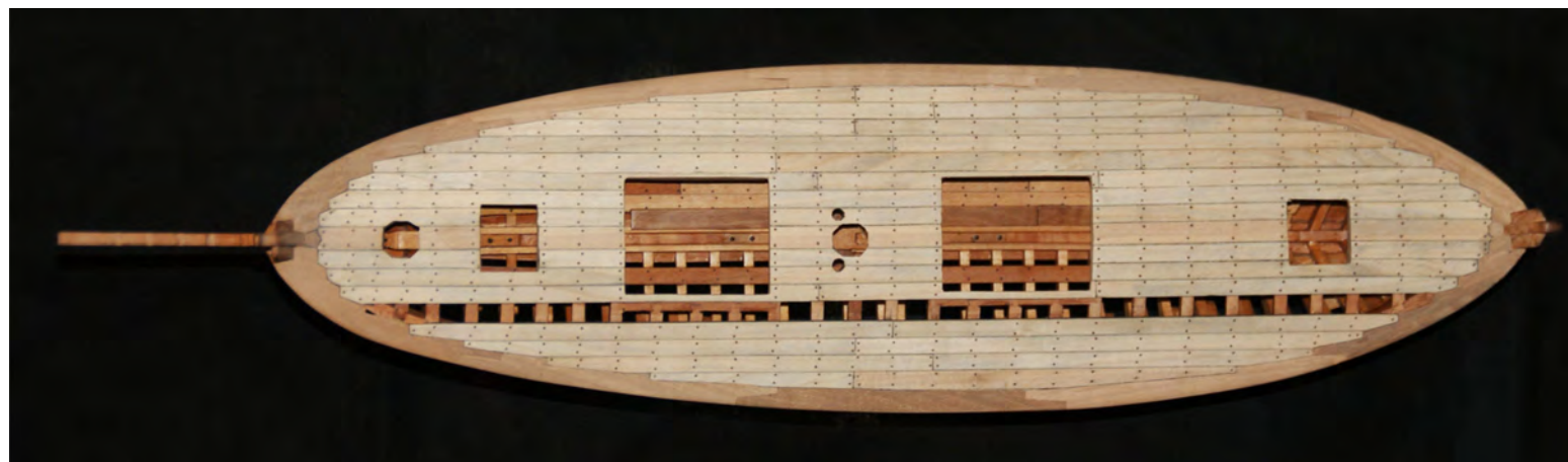
Foto n° 67 - Vediamo il ponte col tavolato e la chiodatura terminata, meno un corso di fasciame, il corso è stato lasciato aperto appositamente in questa foto per far notare la posizione delle corde, tra le corde il fasciame del ponte è più spesso, come anche le corde, vedi dis. 11.
