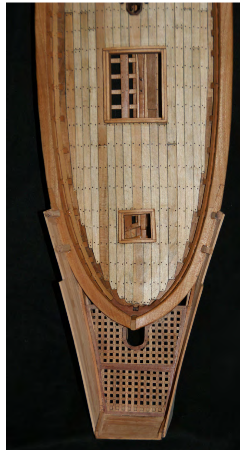
Foto n° 131 - Vista di poppa dall'alto, su questa foto si vede bene la losca del timone.
