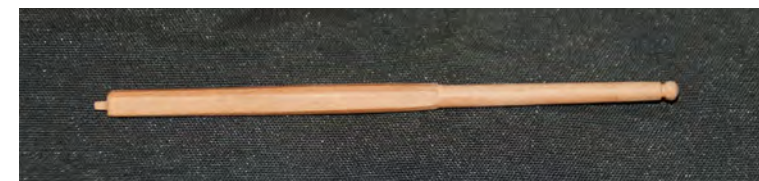
Foto n° 166 - Il bompresso terminato in tutte le sue parti, ora deve solo essere curvato.
