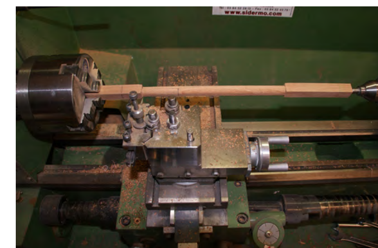
Foto n° 41 - La seconda fase serve a realizzare le due noci che sostengono le colonne del costiere.
