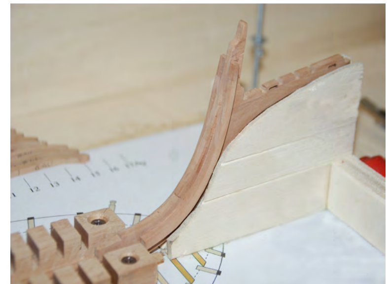
Foto n° 13 - Terminata la battura bisogna realizzare gli apostoli (52), in questo caso quelli di prua uno per lato. Le misure le ricavate dal disegno Tav. 3.
