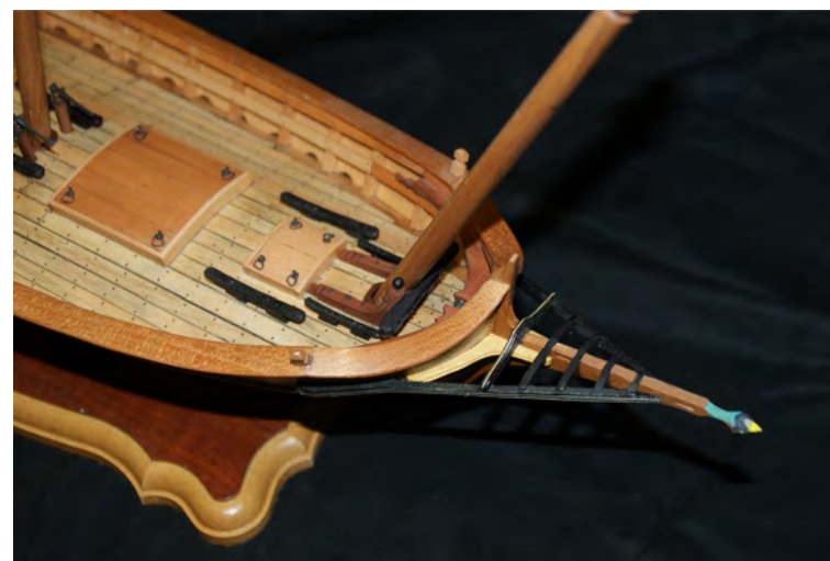
Foto n° 154 - Prua ravvicinata, il grande boccaporto di prua coperto dai suoi quartieri, il piccolo boccaporto di prua anch'esso coperto, con al suo fianco le due galloce,
