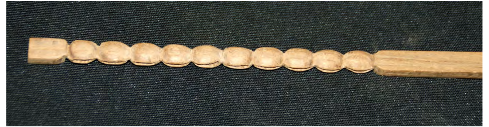
Foto n° 202 - Lavoro dell'utensile n° 2. Risultato dopo la lavorazione.
