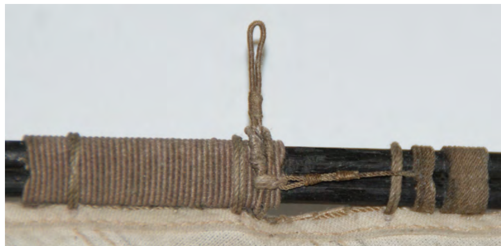
Foto n° 226 - Particolare dell'antenna, vediamo la paròma e al suo fianco la strincafia; la strincafia è una trincatura e serve a non far scorrere la paròma o palòma.
