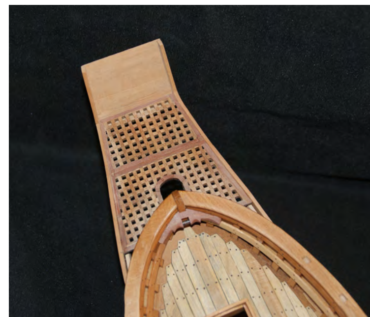
Foto n° 120 - Costruzione della cadrega: i due carabottini e lo scudo di poppa.
