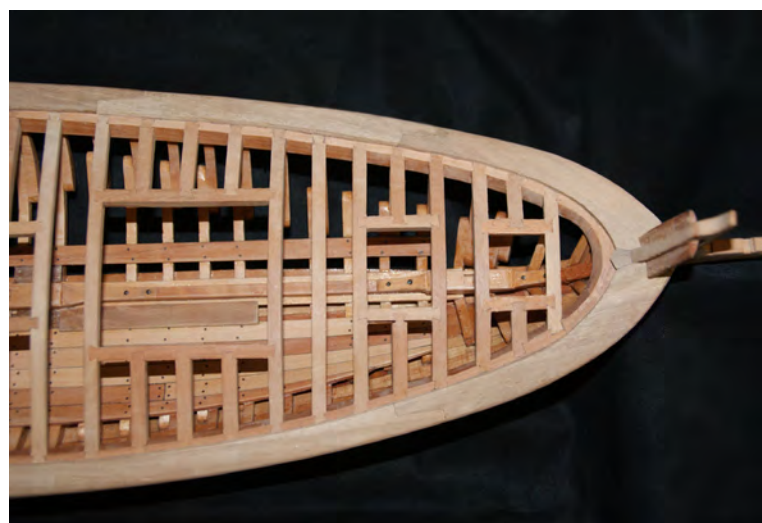
Foto n° 37 - Trincarino 12 x 3 mm. spessore esterno 3,5 mm.
