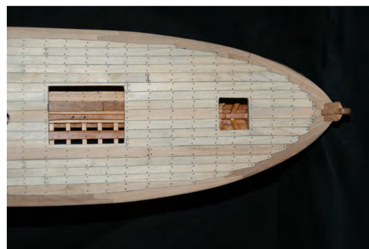
Foto n° 72 - Tavolato del ponte terminato, vista di poppa.
