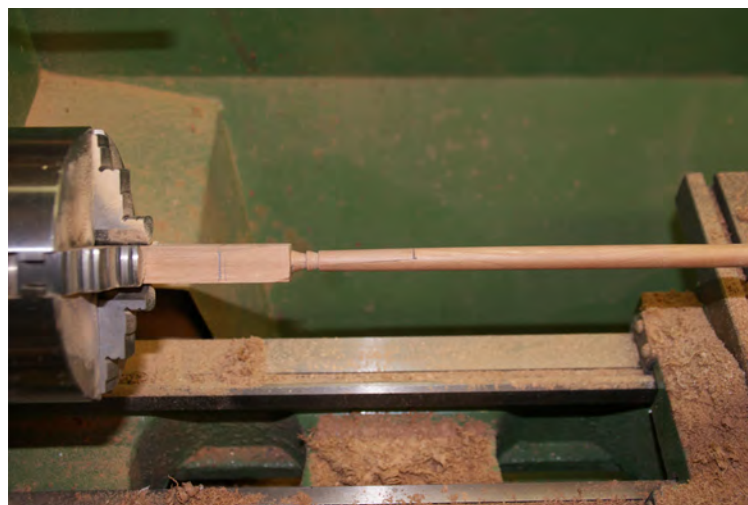
Foto n° 42 - Le noci sono state realizzate, passiamo ora a realizzare la parte interna d'albero di forma ottagonale conica, e il maschio della scassa di forma quadrata.
