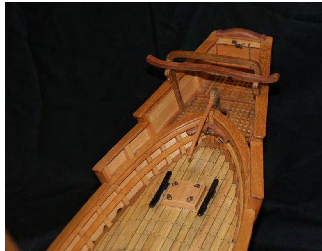
Foto n° 150 - La costruzione della poppa è terminata: la carpenteria delle ali è completa, il timone alloggiato, il piccolo boccaporto è coperto e le due galloce laterali sono installate.
