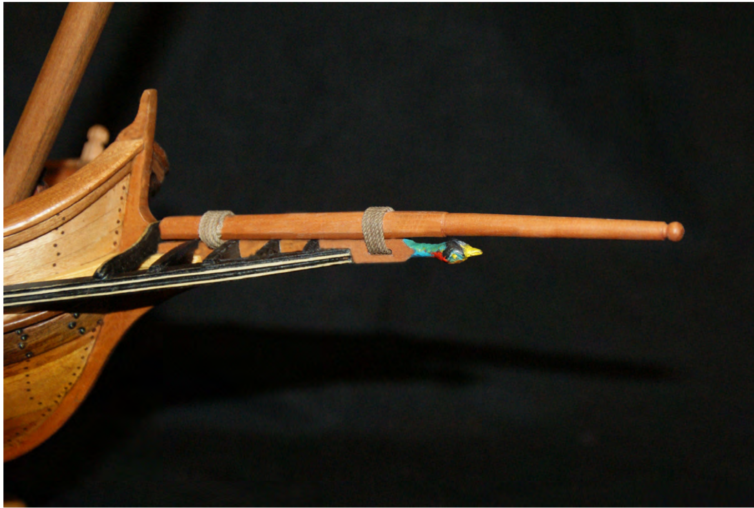
Foto n° 172 - Bompreso messo a dimora e bloccato dalle trince del bompreso. Cavo delle trince \varnothing 1,00 mm..
