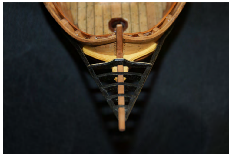
Foto n° 100 - Vista dall'alto dello sperone con tutti i braccioli inseriti.
