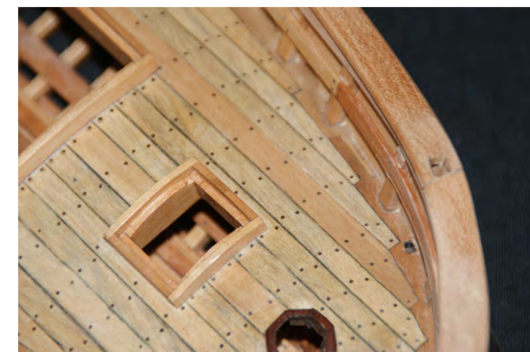
Foto n° 105 - Vista di prua, nel capo di banda si può notare un foro quadrato pronto a ricevere lo scalmotto con la bitta.
