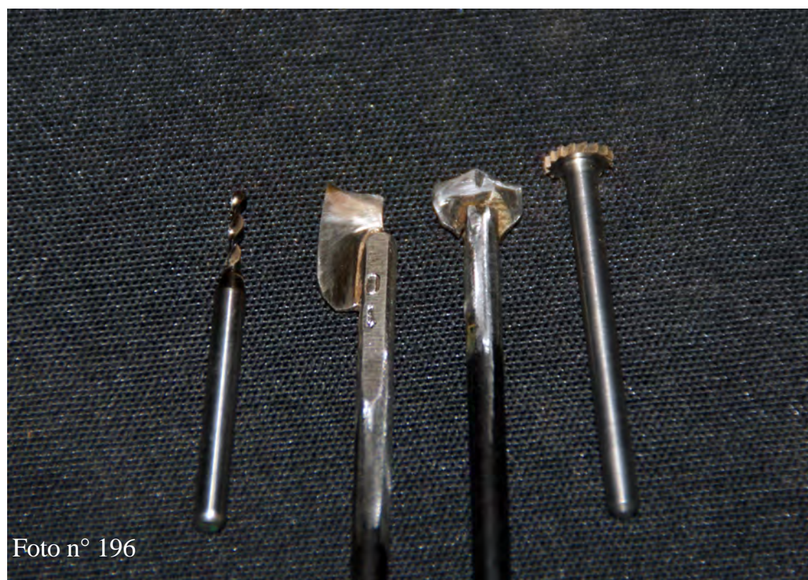
Foto n° 196 - Per realizzare i bozzelli semplici, usando il mio metodo, dobbiamo realizzare degli utensili da taglio, gli utensili da taglio, due per ogni misura di bozzello. Nelle prossime foto spiego il funzionamento di questi utensili o frese realizzati in casa.
