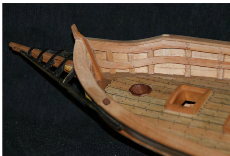
Foto n° 107 - Vista di prua, nel capo di banda, si possono notare i due fori rettangolari pronti a ricevere lo scalmotto con la bitta.
