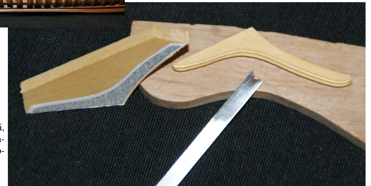
Foto n° 85 - Ultimato il fasciame dell'impavesata, bisogna passare alla chiodatura, chiodi di legno Ø 0.6 mm.
