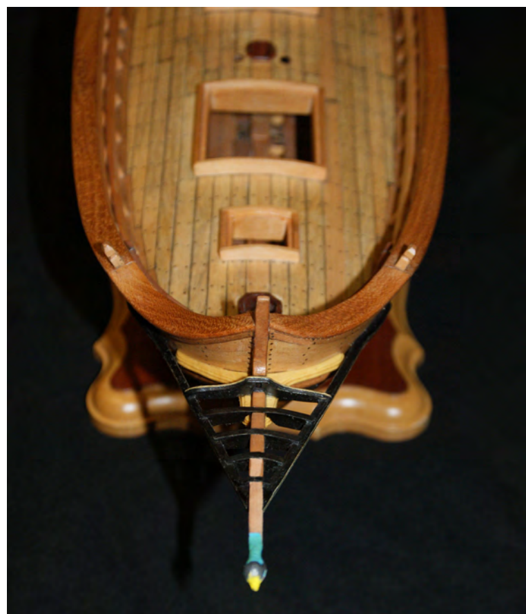
Foto n° 146 - Prua terminata, vediamo lo sperone e la figura messa a dimora, la figura rappresenta un uccello.
