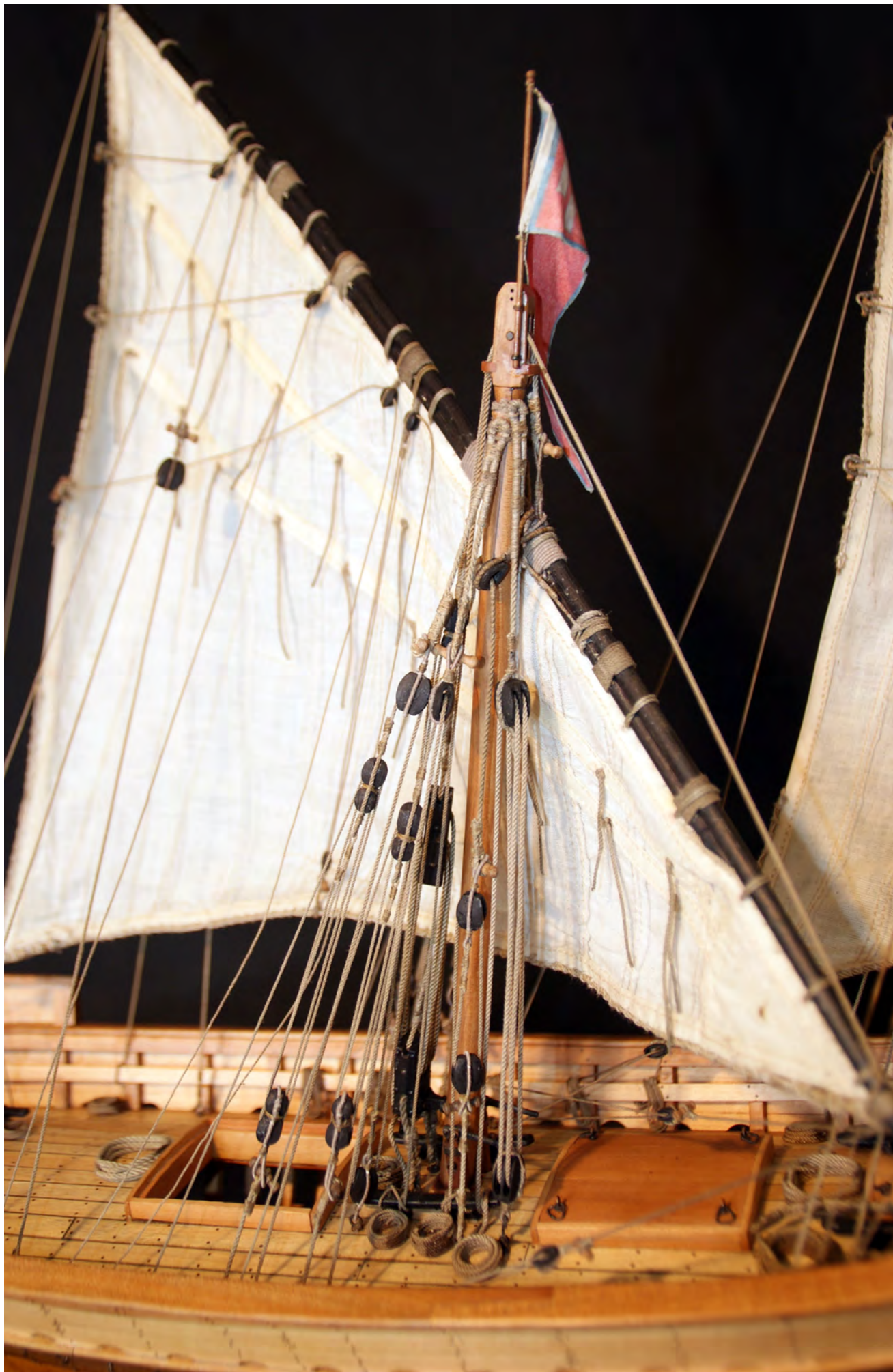
Foto n° 273 - L'albero di maestra completamente armato con tutte le sue manovre sia dormienti che e correnti.
