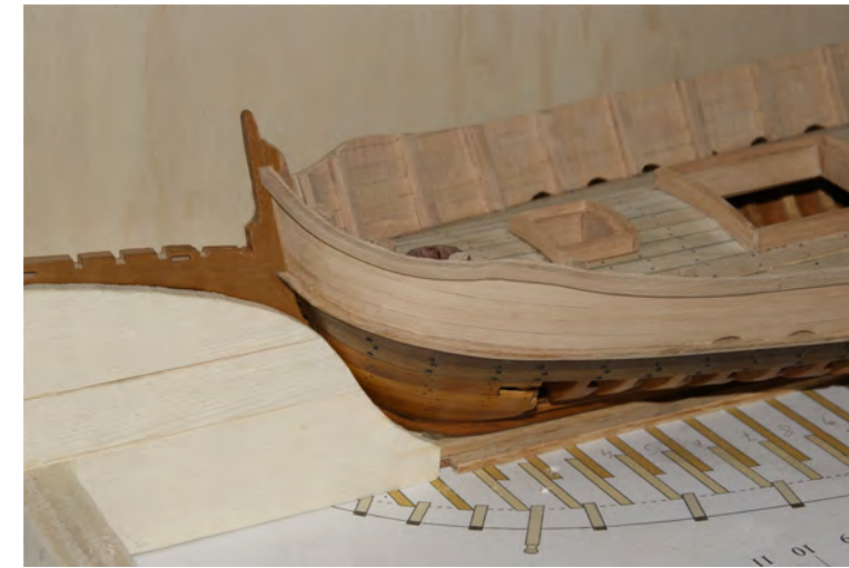
Foto n° 83 - Particolare della prua con l'impavesata finita così come il fasciame di bastingaggio. Su questa foto se ne può notare l'andamento esatto dei corsi di fasciame.
