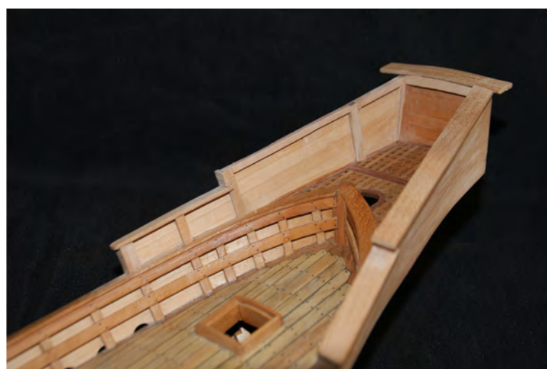
Foto n° 130 - Vista di poppa, all'interno sono stati posizionati altri due scalmotti e sulle ali il capo di banda.
