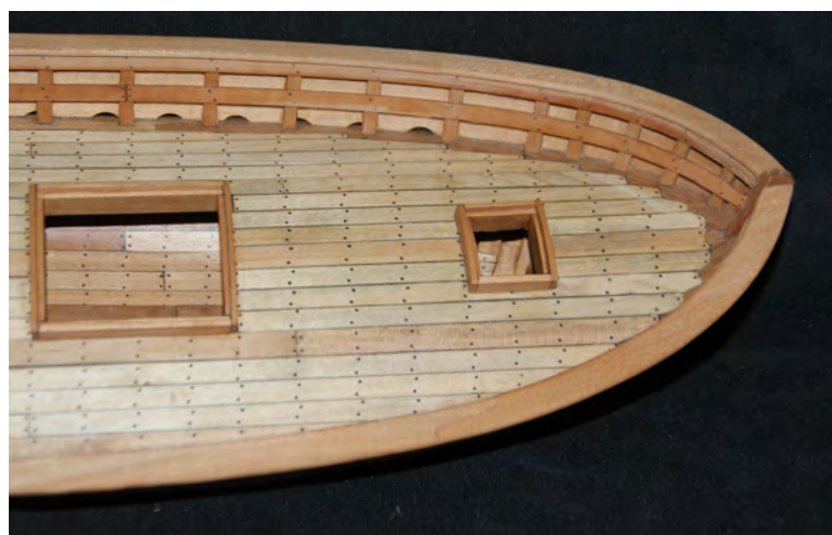
Foto n° 109- Vista di poppa, capo di banda, fasciame di bastingaggio, fasciame dell'impavesata interno, grande boccaporto di poppa, piccolo boccaporto.
