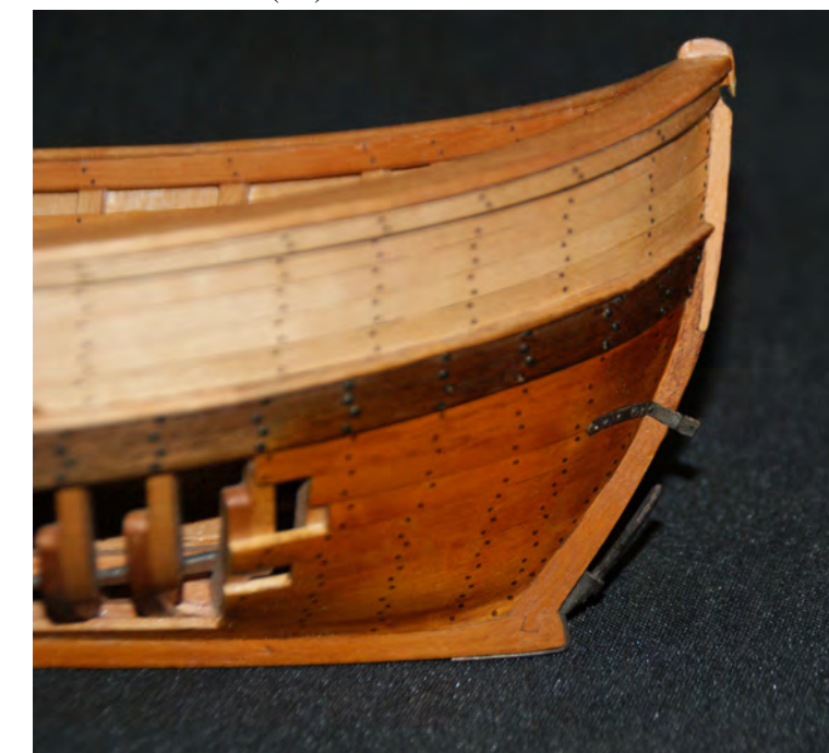
Foto n° 113 - Profilo di poppa, installazione degli agugliotti.
