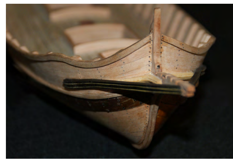
Foto n° 95 - Sperone terminato e messo a dimora. Una volta sistemati i due sostegni laterali dello sperone, passiamo a realizzare i bracci dello sperone: sono 5 ognuno con una sagoma diversa.
