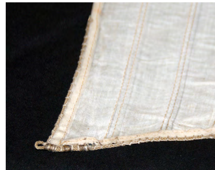
Foto n° 215 - Il gratile della linea di scotta sia inferito alla vela, con la bugna di scotta.
