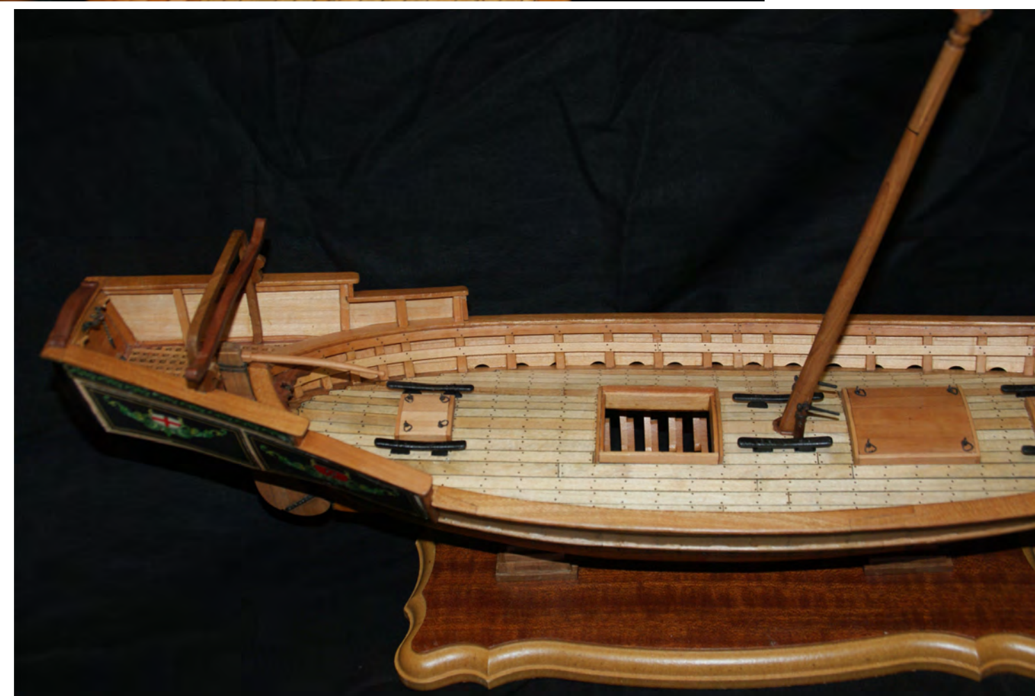
Foto n° 151 - Vista di fianco della poppa: si notano, la carpenteria delle ali, la barra del timone, il piccolo boccaporto di poppa coperto dai quartieri, sui due fianchi le due galloce, il boccaporto grande di poppa aperto, l'albero di maestra a fianco di esso le due pompe di sentina, le due galloce, il grande boccaporto di prua coperto dai suoi quartieri.
