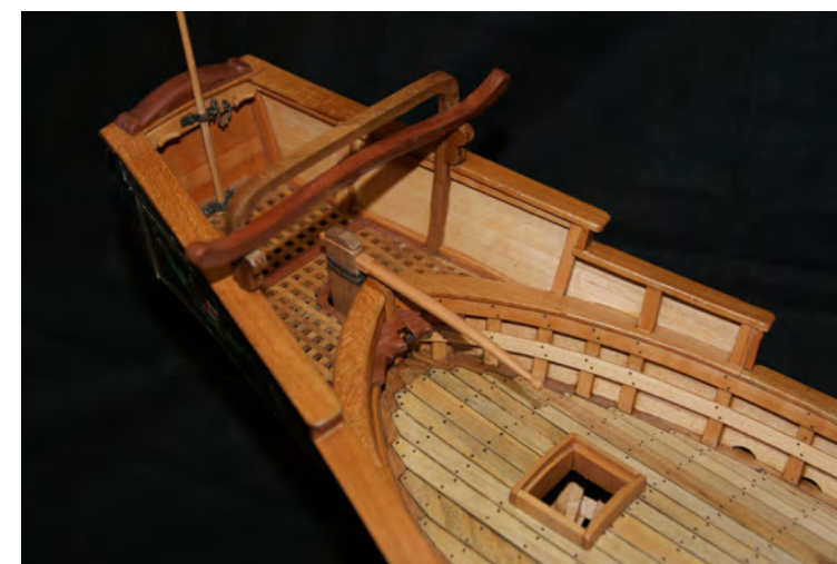
Foto n° 140 - La carpenteria di poppa terminata, col timone inserito nella losca e la barra di comando.
