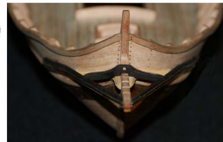
Foto n° 97 - Vista frontale dello sperone e del primo braccio.
