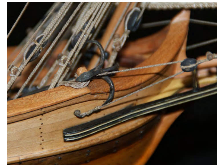
Foto n° 283 - Il ferro grande di prua, posizionamento sul capo di banda.
