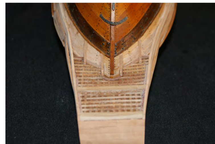
Foto n° 122 - Poppa dello scafo rovesciato per visualizzare, i longheroni e i quattro braccioli di sostegno ai carabottini, la traversa trasversale sotto i carabottini.
