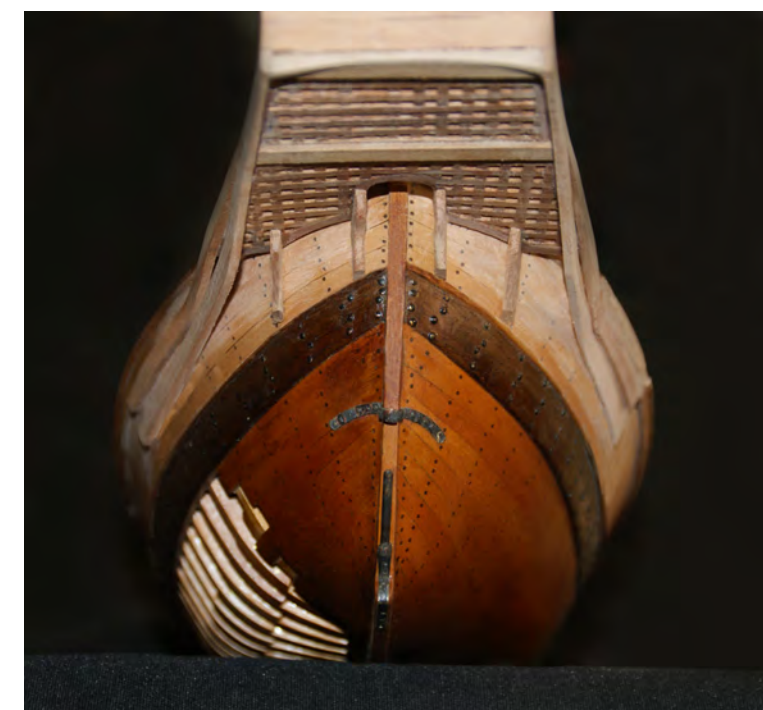
Foto n° 123 - Vista di poppa dal basso verso l'alto. Posizionamento dei braccioli, della traversa trasversale e dei longheroni delle ali.
