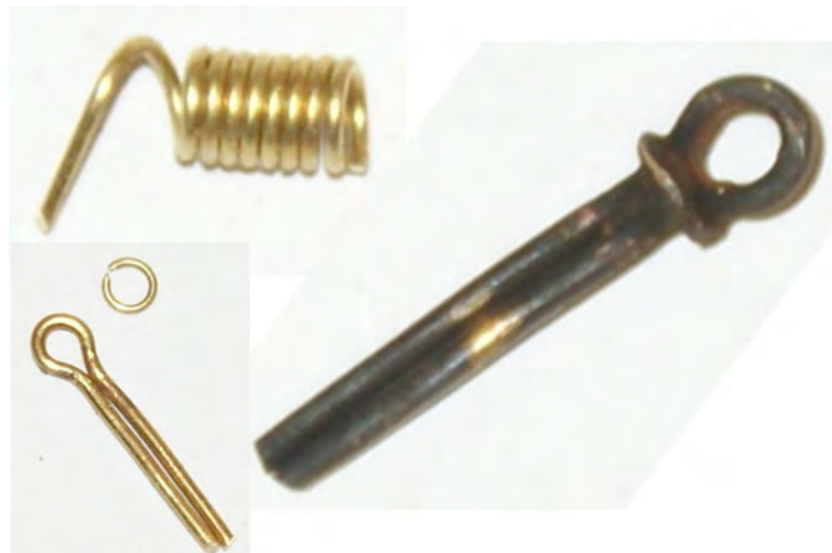
Foto n° 179 - Qui vediamo i tre elementi principali e il golfare terminato e brunito. La terza fase consiste nel realizzare tutti i tipi di bozzelli necessari per realizzare l'attrezzatura velica. Iniziamo le taglie e i taglioni.
