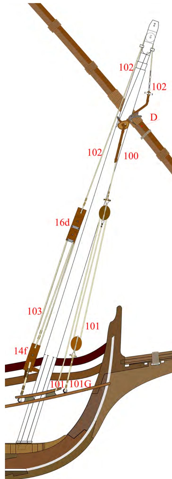
Dis. 30 - In questo disegno abbiamo la drizza completa.
