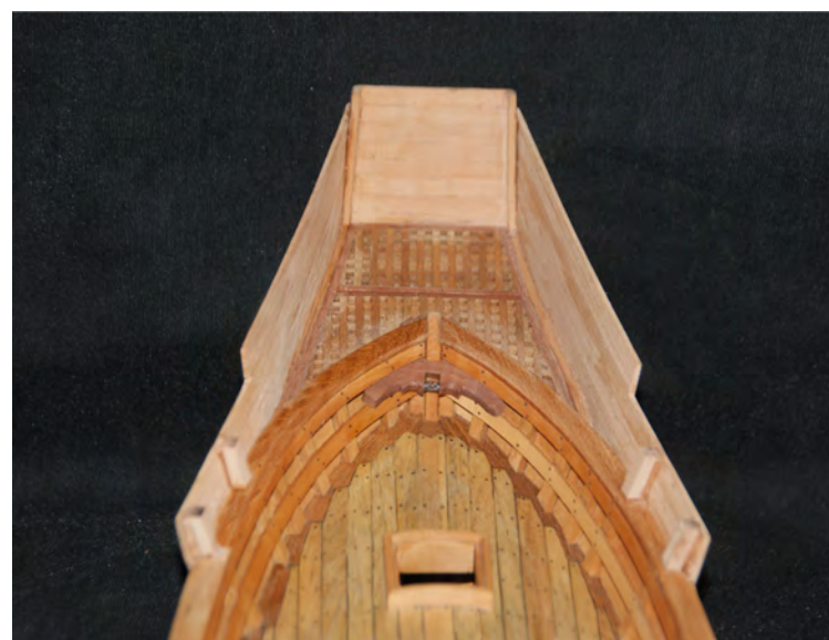
Foto n° 126 - Vista frontale della parte interna della cadrega in costruzione. Visibili gli scalmotti, l'impavesata delle ali e la ghirlanda inserita tra il fasciame di bastinaggio e quello interno dell'impavesata.
