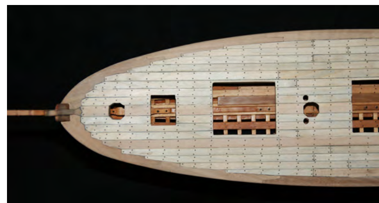
Foto n° 71 - Tavolato del ponte terminato, vista di prua.
