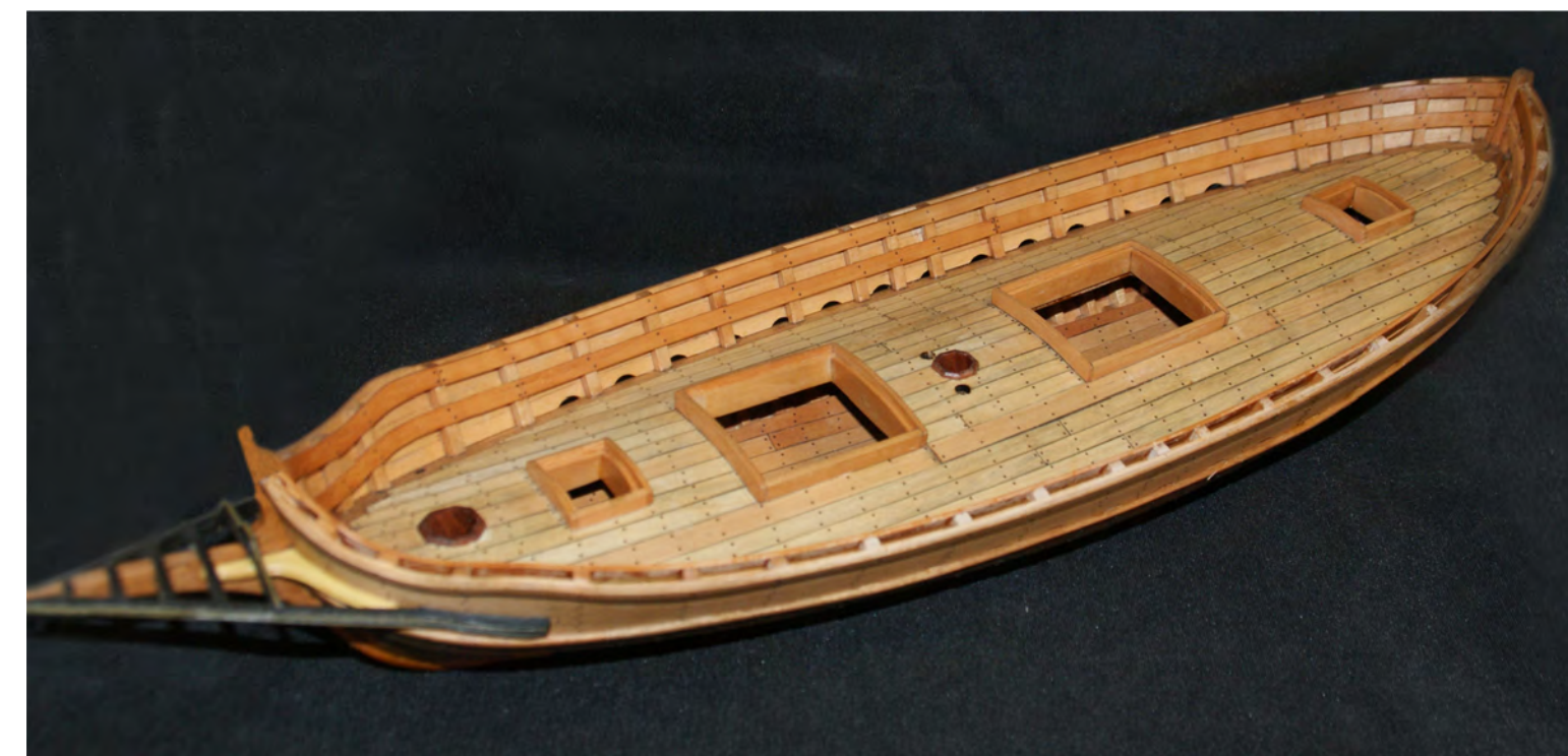
Foto n° 103 - Vista d'insieme del fasciame interno messo a dimora.
