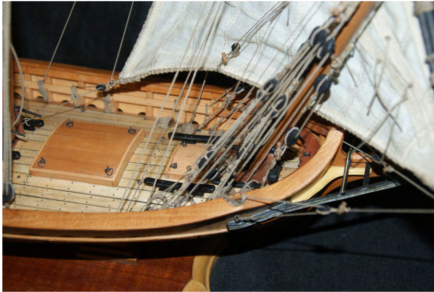
Foto n° 242 - Manovra della scotta da un'altra prospettiva: si nota bene il bozzello stroppato con il coccinello alla bu-gna della vela di trinchetto.
