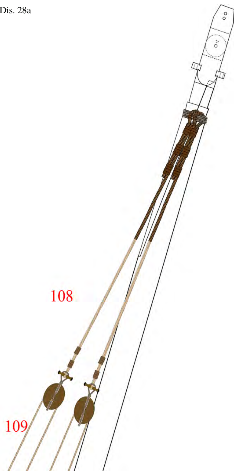
Dis. 28a - La colonna a costiere fa dormiente sulla noce inferiore dell'albero n° 108.
