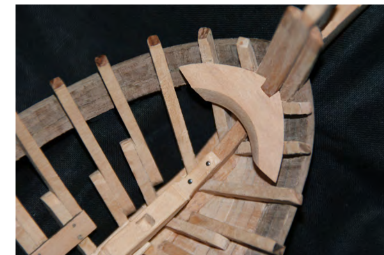
Foto n° 34 - Inserimento della ghirlanda di prua (25), su questa foto possiamo notare che non sono state ancora fatte le scasse per ricevere il dormiente; le scasse sono due, una per lato, sopra la chiglia inserita nel paramezzale possiamo vedere la scassa dell'albero di trinchetto (22).
