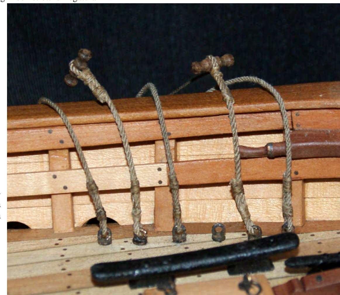
Foto n° 222 - Colonna del costiere dell'albero di trinchetto, l'incappellaggio è uguale su tutti e due gli alberi, variano solo le misure dei cordami; colonna 108 e 112. (maestra). Colonne del costiere (o penzoli 108) sono fasciate per metà della loro lunghezza, per l'esecuzione dell'incappellaggio, si dovranno dare dei giri ben stretti di legatura in-
