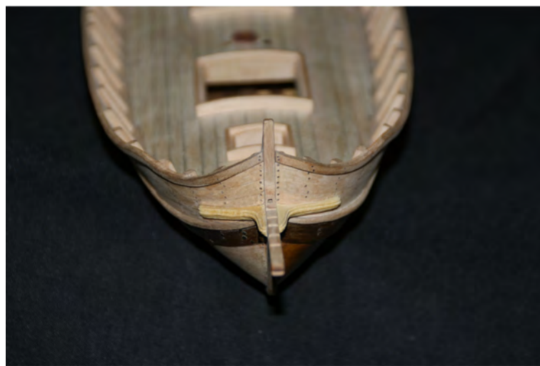
Foto n° 92 - Braccioli, vista frontale, entrambi messi a dimora. Una volta posizionati i braccioli, si passa allo sperone.
