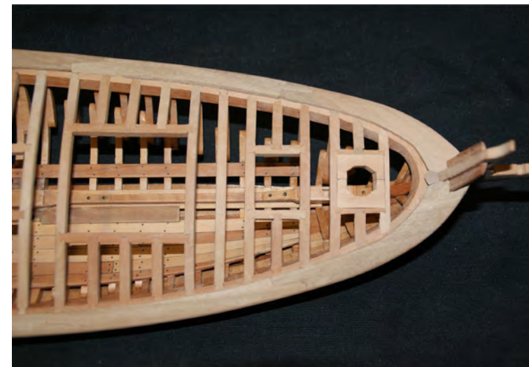
Foto n° 38 - Possiamo ora realizzare i collari che ospiteranno l'albero e i loro rispettivi cunei per il bloccaggio dello stesso, su questa foto vediamo i collari dell'albero di trinchetto.
