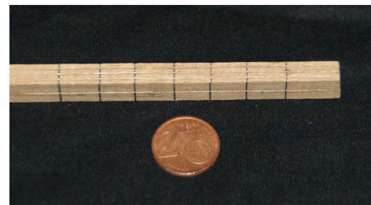
Foto n° 197 - Per realizzare i bozzelli semplici, per primo si prepara un listello delle misure idonee al bozzello di interesse, sia esso ad una oppure a due gole; in seguito dobbiamo segnare a matita sul listello la taglia ed il numero di pezzi di cui abbiamo bisogno.
