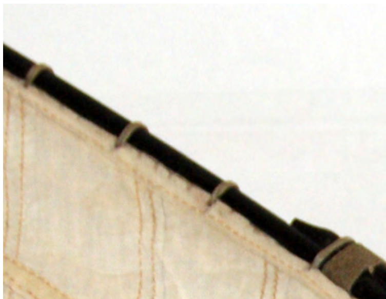
Foto n° 218 - La vela all'antenna viene armata con delle semplici legature.
