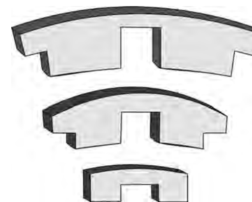
Dis. n° 14 - Terzo, quarto e quinto braccio, con scassa rettangolare, per l'inserimento i braccioli braccioli (sostegni laterali dello sperone).
