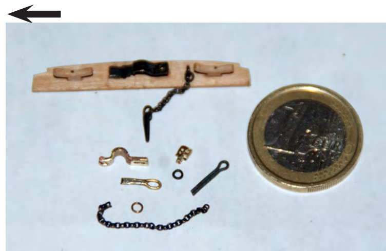
Foto n° 137 - Il collare e dei suoi componenti.
