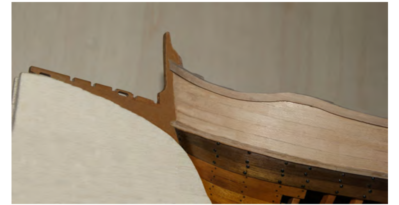
Foto n° 86 - Particolare della prua con l'impavesata finita così come il fasciame di bastingaggio. Su questa foto l'andamento dell'impavesata è ancora più evidente.
