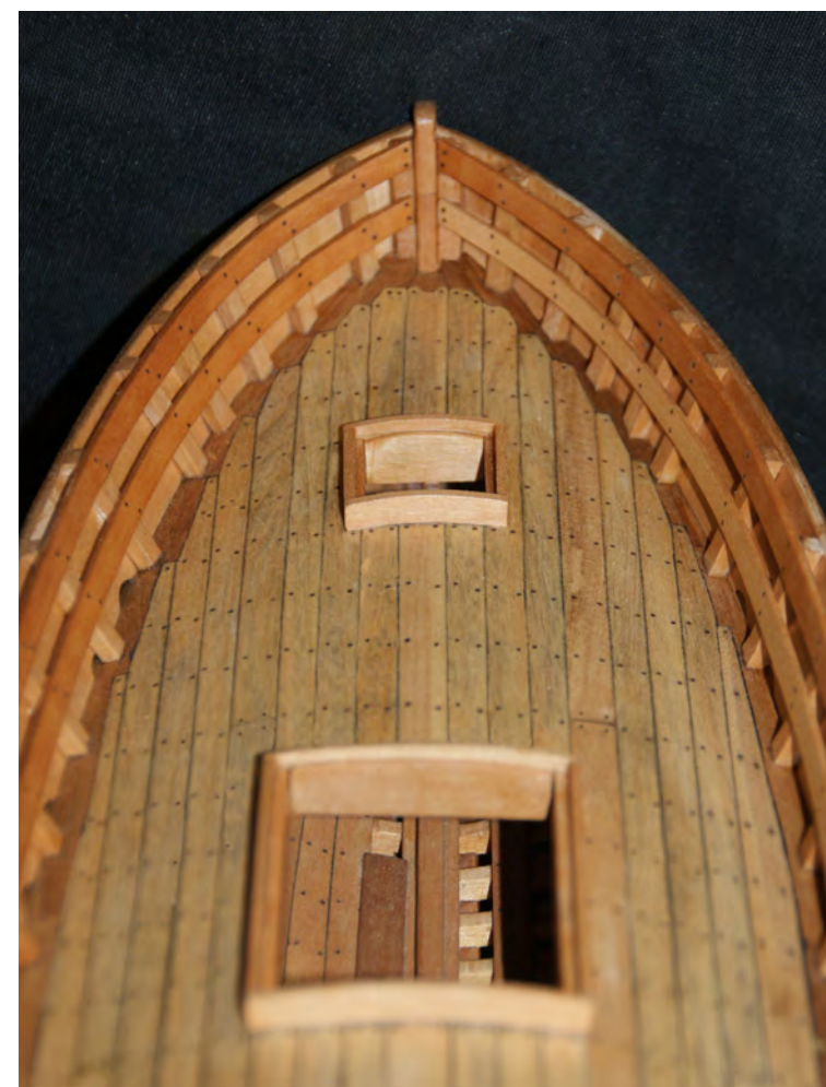
Foto n° 104 - Vista di prua con il capo di banda (61) misure 1,5 x 8 mm. messo a dimora.
