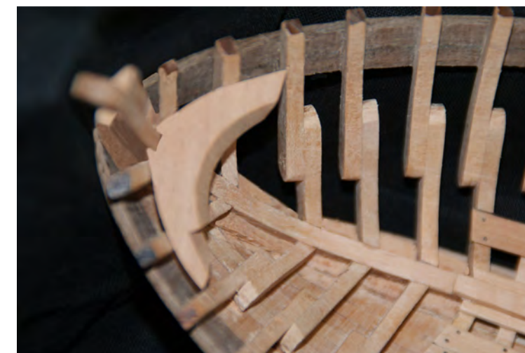
Foto n° 33 - Posizionamento della ghirlanda di poppa (26), sul lato di sinistra della ghirlanda si può notare una scassa pronta a ricevere il dormiente; naturalmente le scasse sono due una per ciascun lato.
