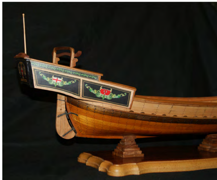
Foto n° 145 - Poppa terminata con il timone messo a dimora e l'asta della bandiera inserita.
