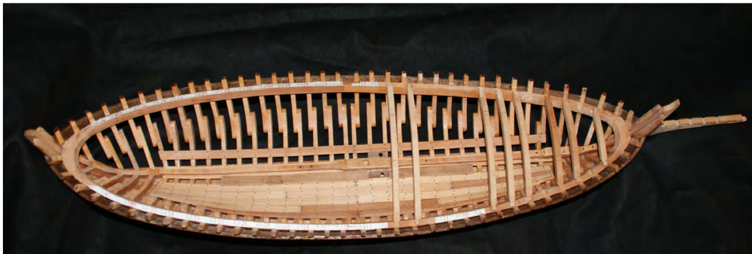
Foto n° 35 - Le due ghirlande il dormiente (27) e alcuni bagli in posizione.
