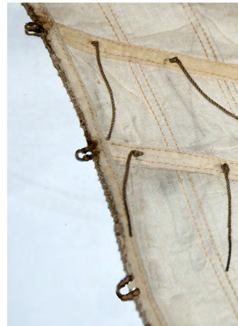
Foto n° 216 - Le vele possono essere attrezzate in modo diverso: la vela di trinchetto ha due brancarelle per gli imbrogli, mentre la vela di maestra ne ha tre. I terzaruoli di entrambe le vele hanno un Ø 0.70 mm.
