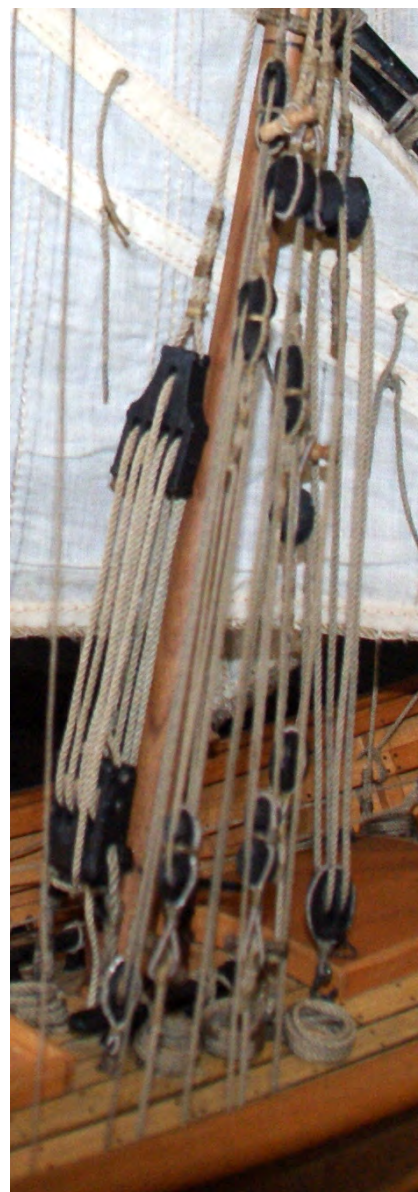
Foto n° 259 - In primo piano il mantiglio del carro (138): in alto il bozzello a violino, in basso il bozzello semplice.
