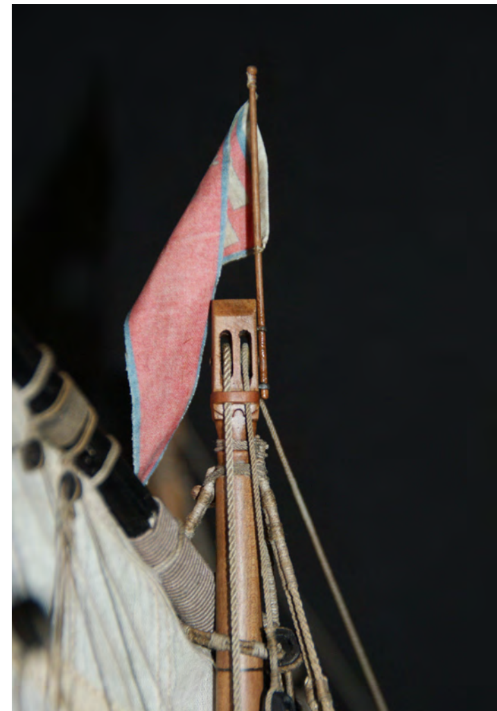
Foto n° 252 - Testa a calcese: vediamo il passaggio del carnale e del mantiglio del carro.
