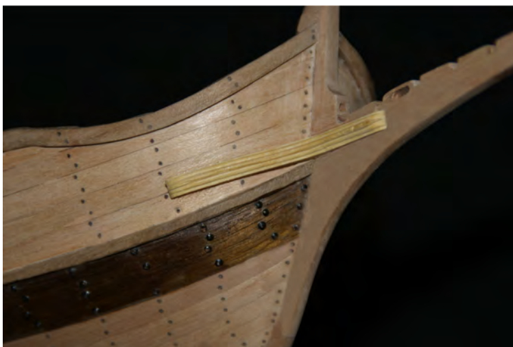
Foto n° 91 - I braccioli dello sperone messi a dimora.
