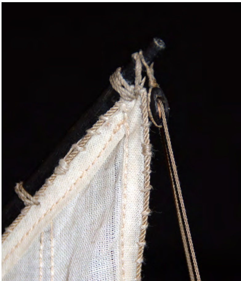
Foto n° 266a - Particolare del bozzello semplice stroppato alla penna.
