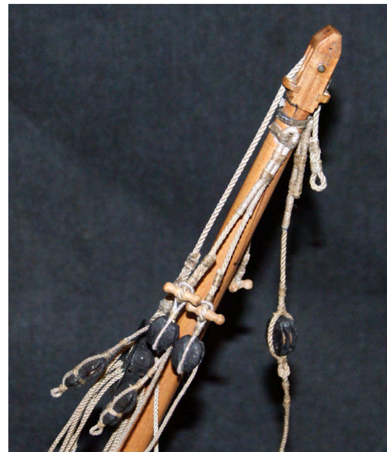
Foto n° 222 - Colonna del costiere dell'albero di trinchetto, l'incappellaggio è uguale su tutti e due gli alberi, variano solo le misure dei cordami; colonna 108 e 112. (maestra). Colonne del costiere (o penzoli 108) sono fasciate per metà della loro lunghezza, per l'esecuzione dell'incappellaggio, si dovranno dare dei giri ben stretti di legatura in-
