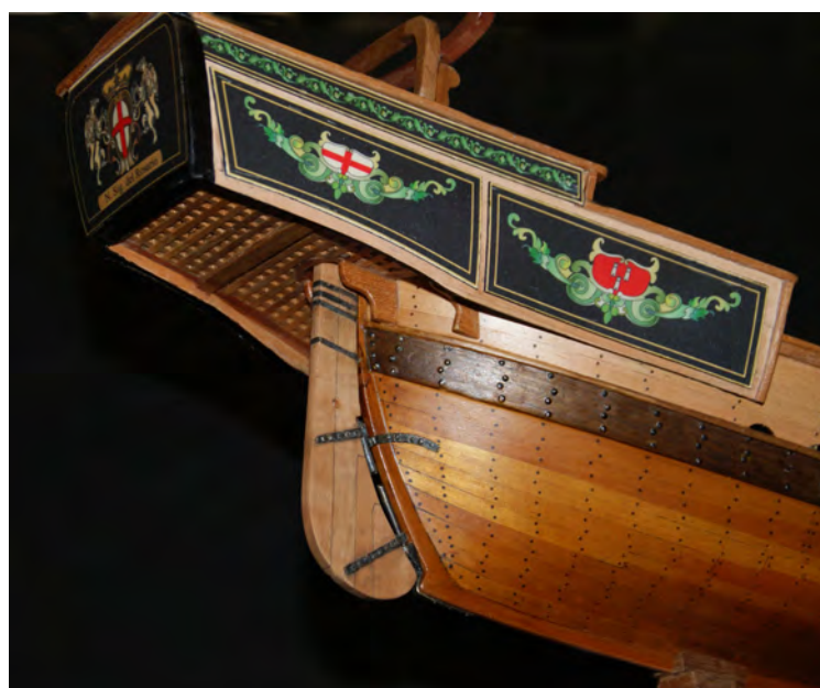
Foto n° 157 - Poppa terminata con vista dal basso verso l'alto, si vede la carpenteria di poppa decorata, il pagliolato e il timone.
