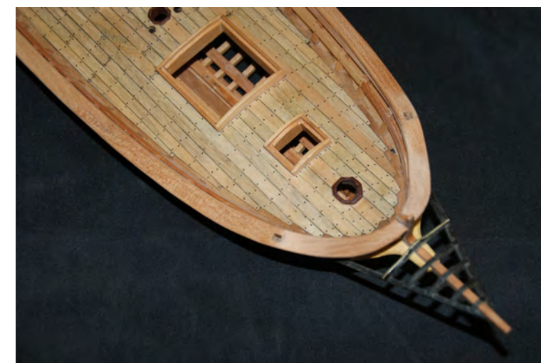
Foto n° 104 - Vista di prua con il capo di banda (61) misure 1,5 x 8 mm. messo a dimora.
