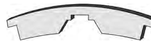
Dis. n° 13 - Secondo braccio; questo oltre ad avere la scassa rettangolare ha anche una svasatura per poterlo inserire tra i braccioli braccioli (sostegni laterali dello sperone).
