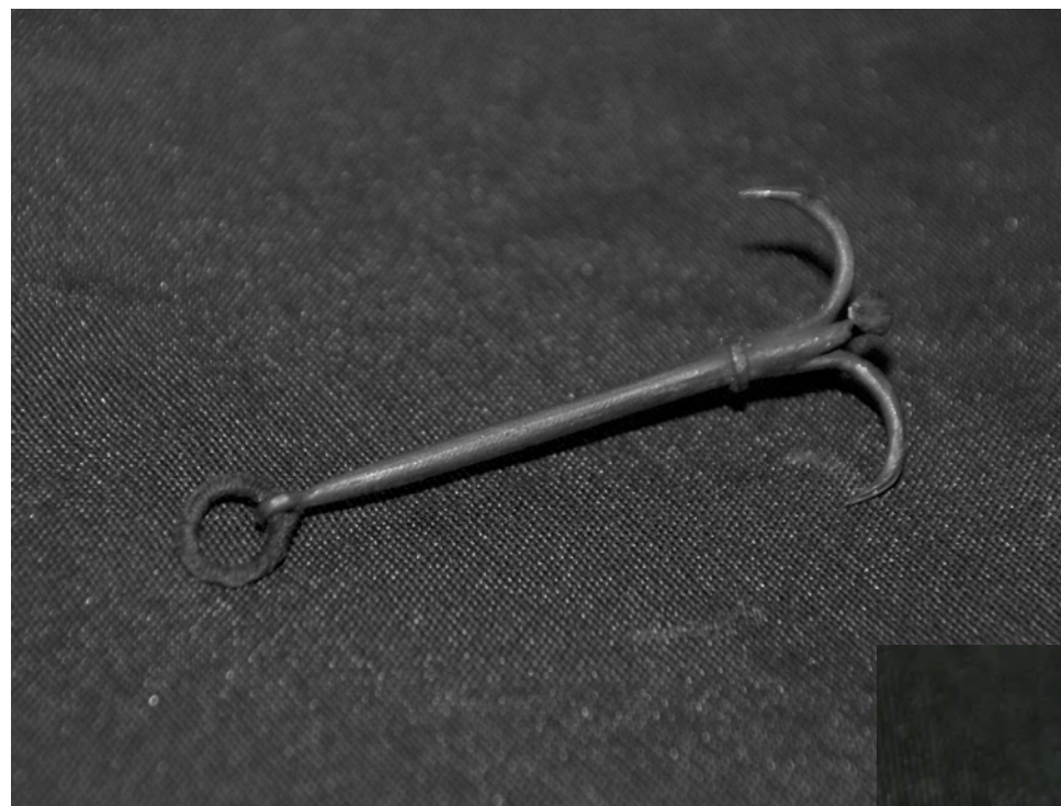
Foto n° 277 - Ferro o ancorotto finito completo di brunitura.
