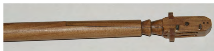
Foto n° 51 - Albero a calcese terminato, nella foto, oltre ai distanziali sono già presenti i due golfari che servono a ricevere l'alberetto della freccia.
