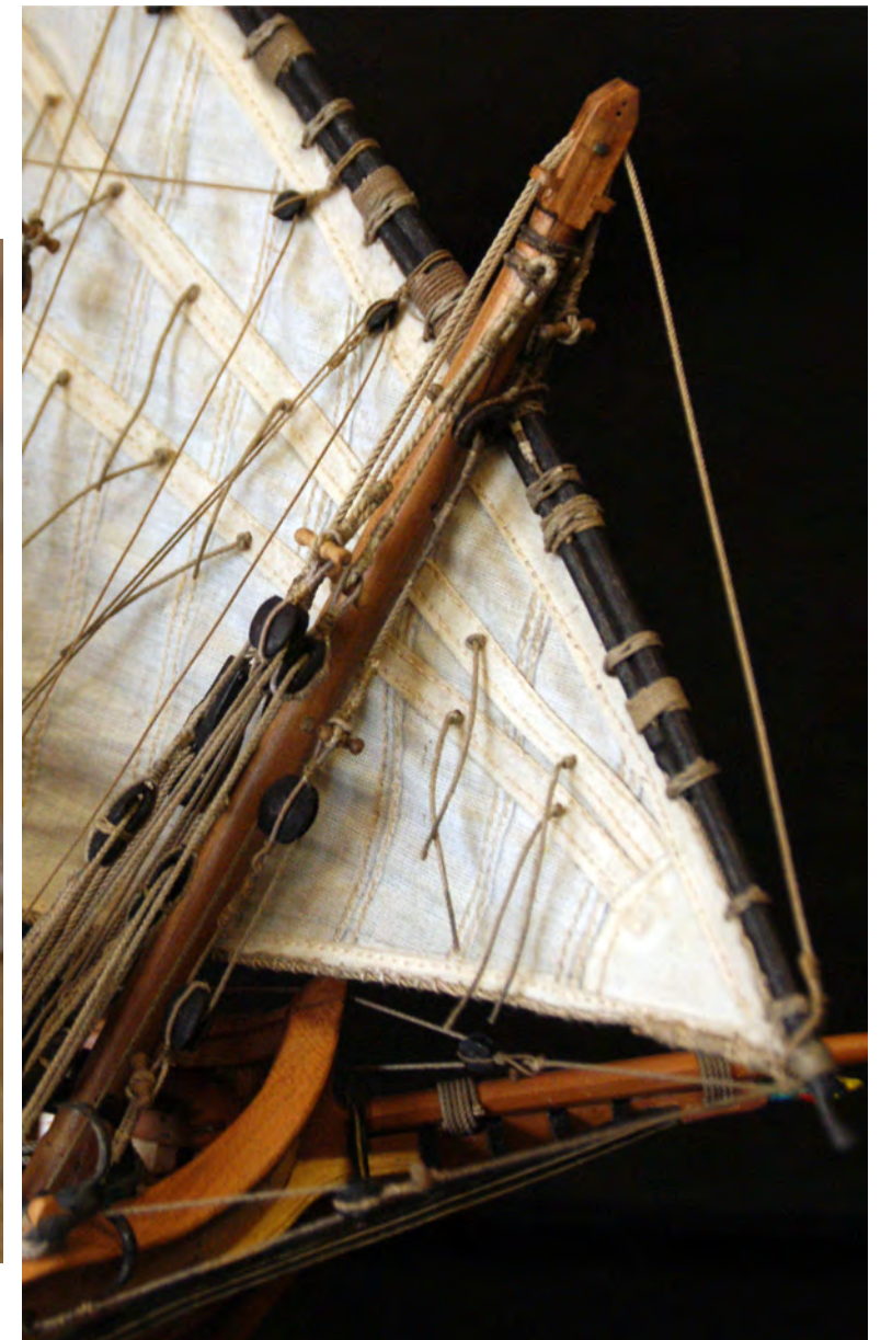
bozzello a violino. Questo, a sua volta fa paranco con un bozzello semplice arridato a un golfare a piè d'alberoe dà volta sul fasciame dell'impavesata.
