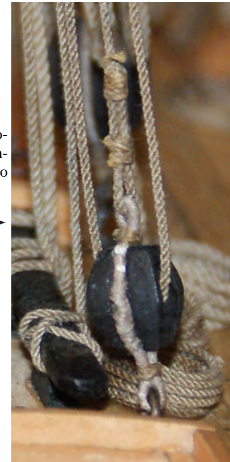
Dis. 32a - Il mantiglio (140) fa dormiente nella parte bassa dell'antenna (carro), passa attraverso una gola del calcese, e si va a stroppare direttamente sul bozzello a violino.
