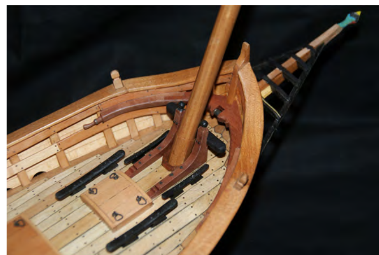
Foto n° 155 - Ponte di prua: il piccolo boccaporto coperto, con a fianco le due galloce, il bottone di prua, con a fianco le due galloce piccole l'albero di trinchetto, le due bitte nel capo di banda, La grande ghirlanda e lo sperone.
