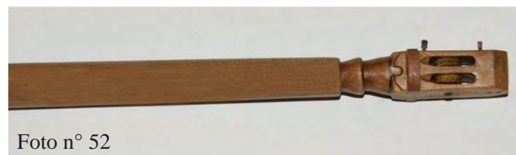
Foto n° 51 - Albero a calcese terminato, nella foto, oltre ai distanziali sono già presenti i due golfari che servono a ricevere l'alberetto della freccia.
