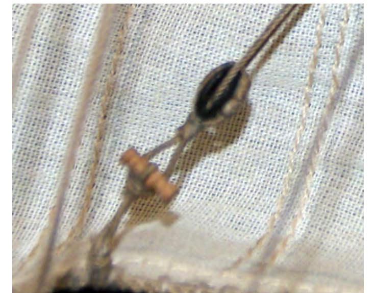
Foto n° 272 - Lo sbirro è stroppato sul gratile della linea di scotta, sull'altra estremità a un coccinello, il bozzello è stroppato sul coccinello.
