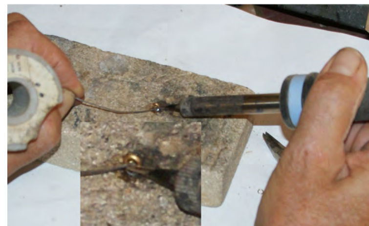
Foto n° 178 - Completamento del golfare. Bisogna infilare il golfare nell'occhiello, inserirlo in questo panetto morbido per saldature per orafi e procedere alla saldatura a stagno. Il panetto ignifugo utilizzato come superficie da per saldare si chiama Magnesia Soldering Block. Si può reperire in America: http://www.ottofrei.com/ .
