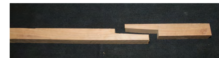
Foto n° 39 - Si procede alla realizzazione dell'albero dopo la giunzione e l'incollaggio.
