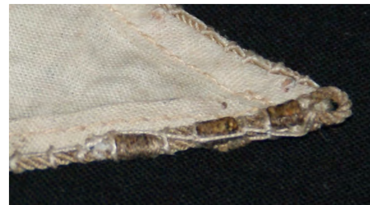
Foto n° 214 - Il gratile della linea di scotta è inferito alla vela, con la bugna di mura.
