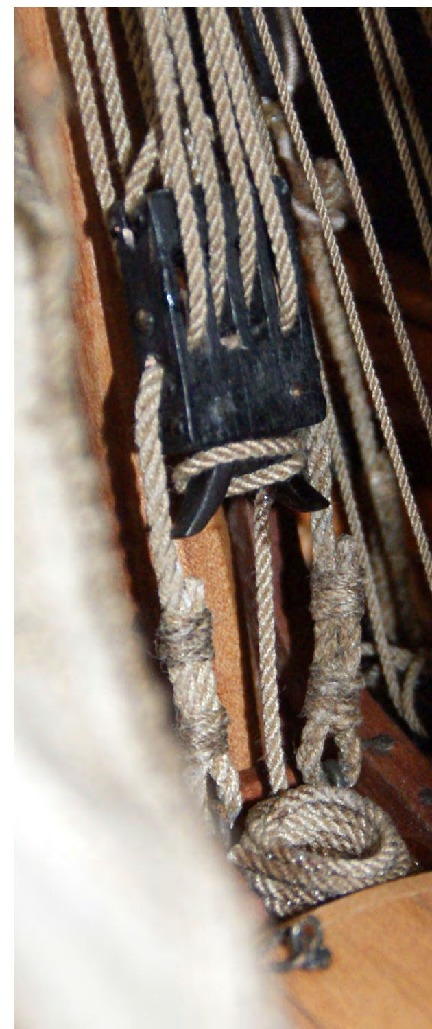
Foto n° 230 - Particolare del taglione, nell'estremità bassa del taglione abbiamo la galloccia, il senale fa dormiente sulla galloccia. Il taglione è amarrato al ponte, tramite uno sbirro passante che fa dormiente su due golfari fissati al ponte.
