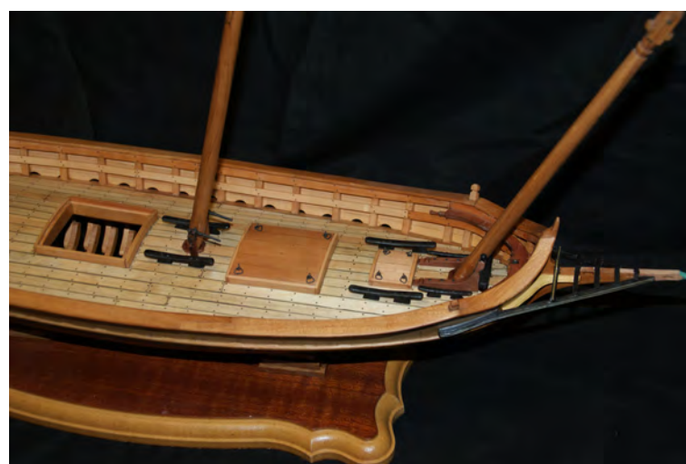
Foto n° 153 - La prua, con il boccaporto grande di poppa aperto, l'albero di maestra con al suo fianco le due pompe di sentina, le due galloce, il grande boccaporto di prua coperto dai suoi quartieri, il piccolo boccaporto di prua anch'esso coperto, con affianco le due galloce, il bottone di prua, l'albero di trinchetto.
