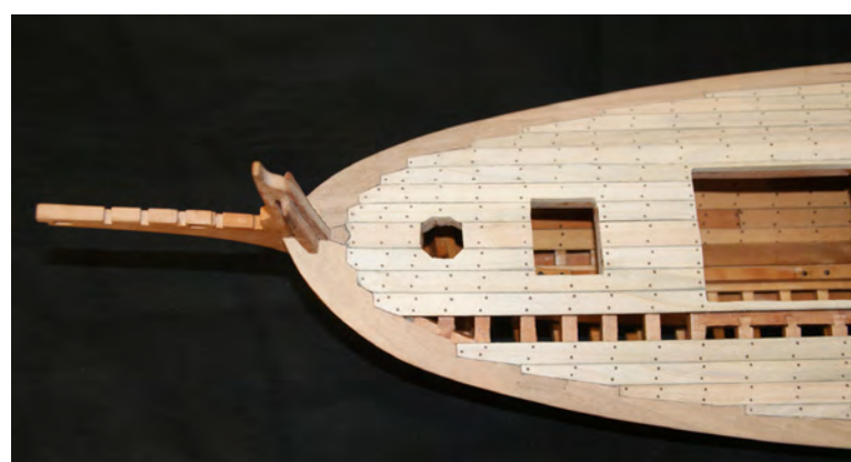
Foto n° 70 - Tavolato del ponte, vista di poppa con il piccolo boccaporto; la chiodatura del ponte è del Ø 0.6 mm.
