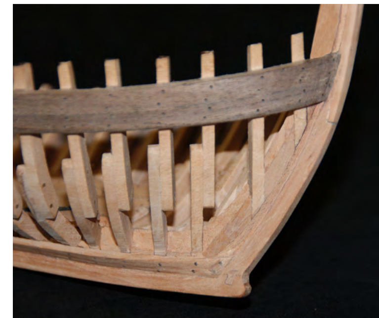
Foto n° 22 - Linea dei garbi deviati e curva delle cinte. Ultimato il montaggio dei garbi è meglio procedere al montaggio degli incintoni (o cinte) su entrambi i lati, in modo da bloccare l'intera struttura, in seguito fissare i due corsi di fasciame più prossimi alla chiglia (torello e controtorello). Si passa poi al montaggio del paramezzale; quest'ultimo (2) è composto da 3 pezzi, quello centrale e più largo perché deve ospitare il piede dell'albero e serve da scassa.
