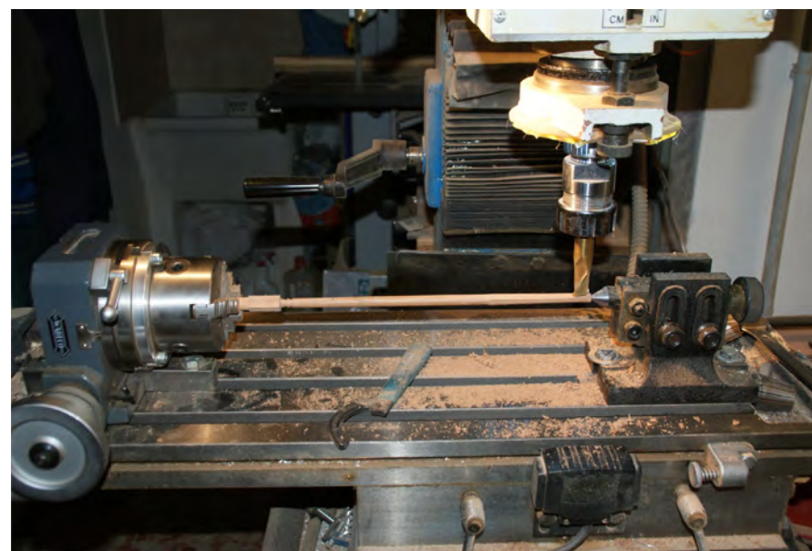
Foto n° 43 - In questa fase stiamo realizzando la parte ottagonale conica.
