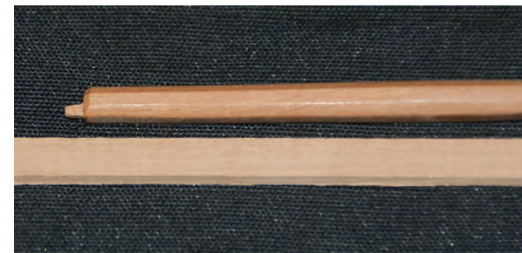
Foto n° 169 - Particolare della base ottagonale del bompresso: il tenone è decentrato e la parte bassa dell'ottagono è appiattita per aderire bene al tagliamare.
