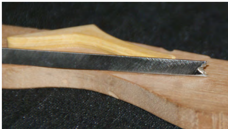
Foto n° 89 - In questa foto possiamo vedere l'esatta sagoma dell'utensile; per realizzare questi utensili utilizzo delle lame per seghetto a ferro adoperate dai fabbri per tagliare le putrelle.
