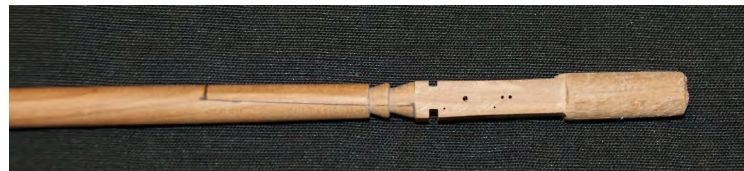
Foto n° 46 - Il calcese d'altro lato, si notano le due scanalature che ricevono i distanziali, il foro per il perno delle pulegge e due fori di servizio, usati in casi di necessità, ma nel modello non sono attrezzati.
