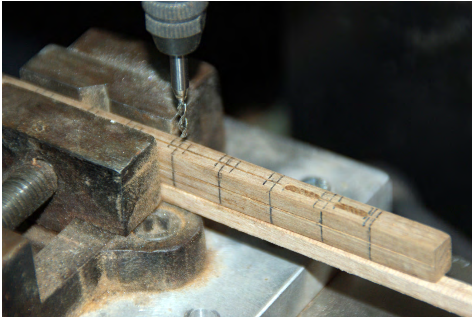
Foto n° 200 - Quarta fase, consiste nel forare la cassa con l'utensile n° 3, una fresa.
