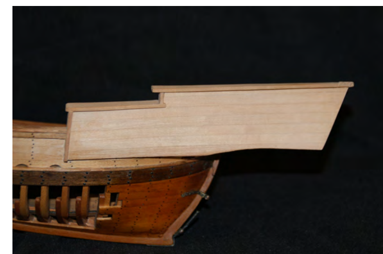
Foto n° 132 - Cadrega, parte esterna delle ali con il capo di banda messo a dimora.
