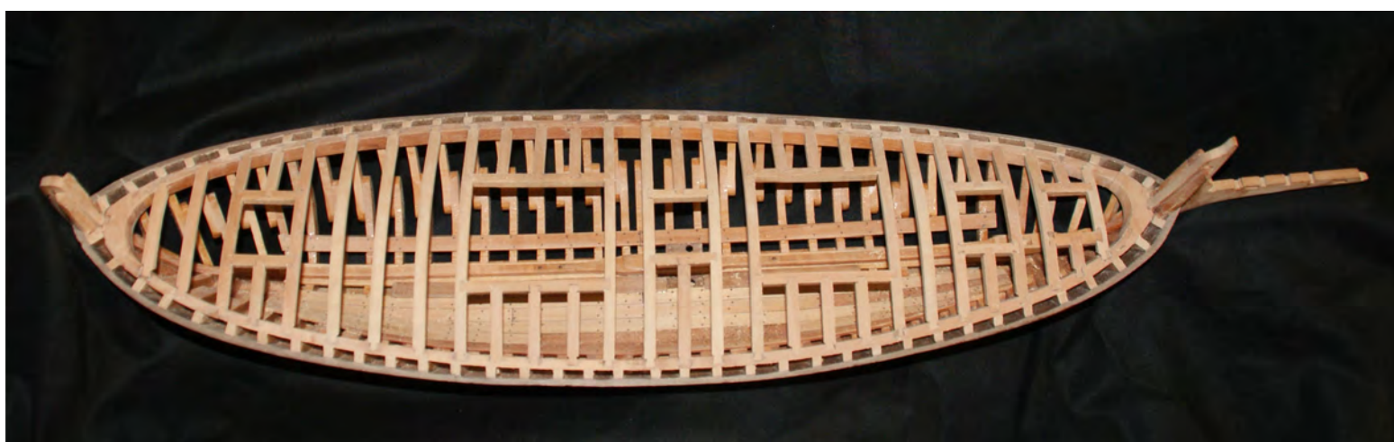
Foto n° 36 - Vista completa della struttura del ponte: le due ghirlande fornite di incastri per i dormienti, i dormienti e tutti i bagli (28), i mezzi bagli (28) e le relative aperture in opera. Partendo da prua la prima apertura è pronta a ricevere la mastra dell'albero di trinchetto (29), la seconda apertura è per il boccaporto piccolo (36), la sesta per il boccaporto piccolo (36).
