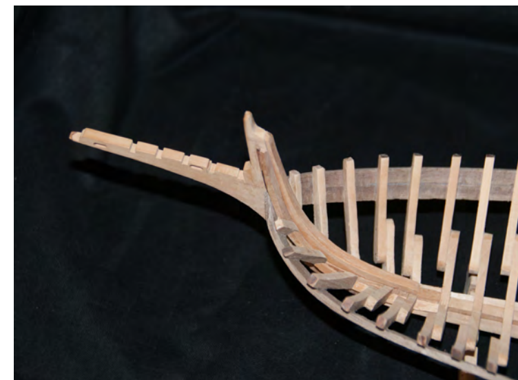
Foto n° 21 - Per il montaggio dei garbi deviati di prua e di poppa l'angolo di quarta buono va eseguito sul piede del madiere, il madiere e lo staminale devono seguire la curva dello scafo.
