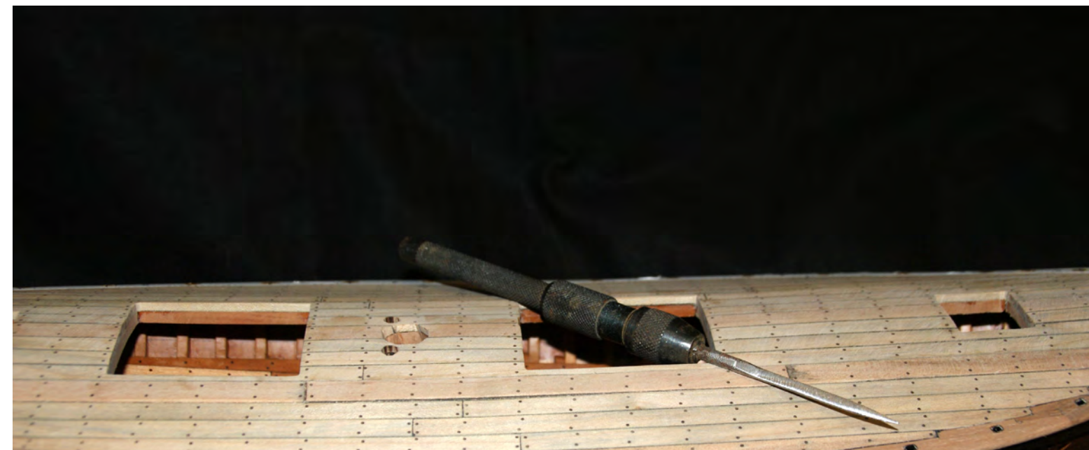
Foto n° 73 - Preparazione dei fori sul trincarino per poter inserire gli scalmotti dell'impavesata.
