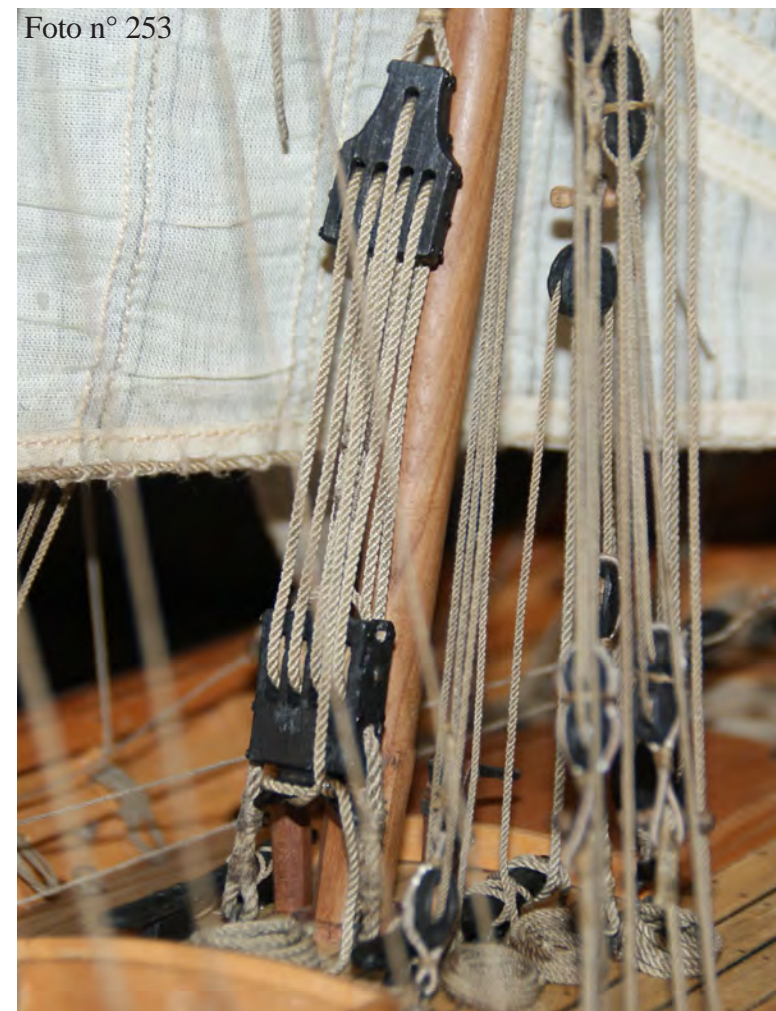
Foto n° 252 - Testa a calcese: vediamo il passaggio del carnale e del mantiglio del carro.
