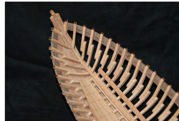
Foto n° 31 - In evidenza la disposizione dei garbi deviati, del tavolato dei fondi e del fasciame esterno ultimato.
