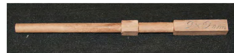
Foto n° 58 - La lunghezza del pezzo da lavorare dipende dal disegno e da come voi pensate di realizzare le pompe; ad ogni buon conto la prima fase consiste nel fare al tornio il pezzo (vedi foto 59). La lunghezza è in funzione del disegno e da come voi pensate di realizzare le pompe.
