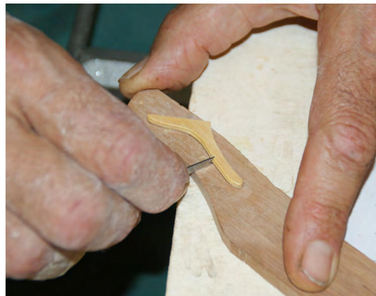
Foto n° 90 - Per realizzare al meglio la modanatura ho incollato il bracciolo su un pezzo di legno perfettamente piallato in modo da facilitare lo scorrimento, e per avere una miglior tenuta del pezzo; una volta terminata la modanatura, per staccare il bracciolo dal supporto, basta bagnare il bracciolo con del solvente (acetone). L'acetone riesce a scollare qualunque tipo di colla, anche quella cianoacrilica.
