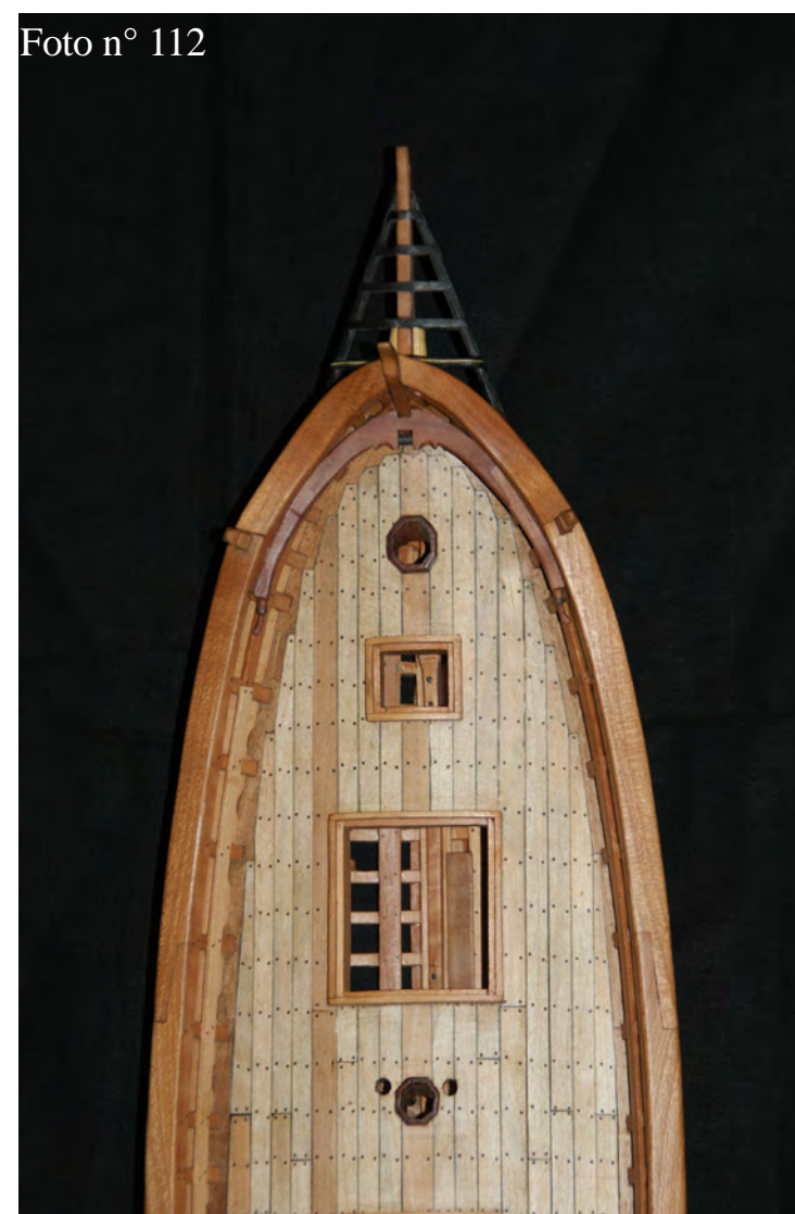
Dis. n° 15 - Struttura della ghirlanda di prua (54).
