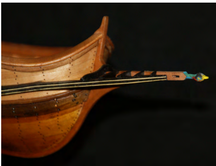
Foto n° 146 - Prua terminata, vediamo lo sperone e la figura messa a dimora, la figura rappresenta un uccello.
