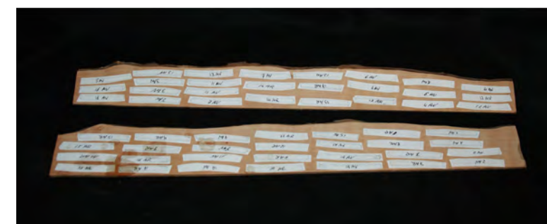
Foto n° 75 - Gli scalmotti posizionati sulle tavolette pronti per essere tagliati. Gli scalmotti sono ricavati dalle tav. 4 e 5, come già accennato in precedenza bisogna solo adoperare gli scalmotti che hanno il disegno con linea continua.
