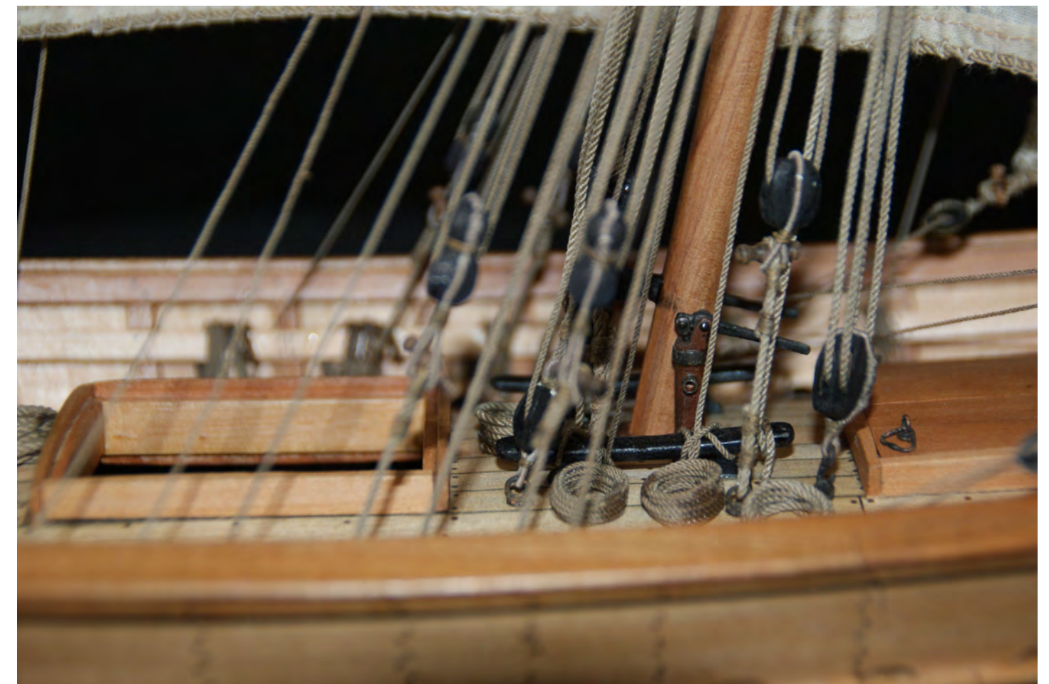
Foto n° 248a - Particolare delle manovre dell'albero di maestra.
