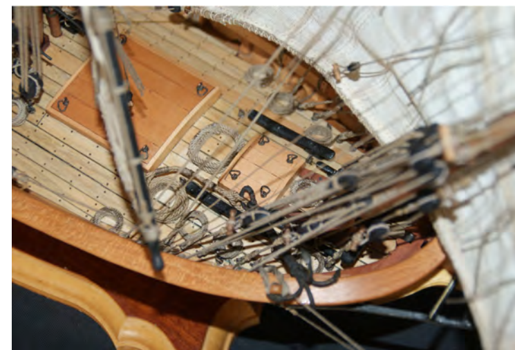
Foto n° 283 - Il ferro grande di prua, posizionamento sul capo di banda.
