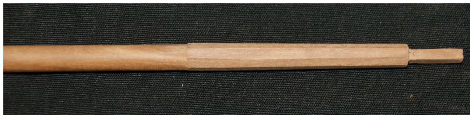
Foto n° 44 - La parte sottocoperta dell'albero è ottagonale e termina con il maschio della scassa.
