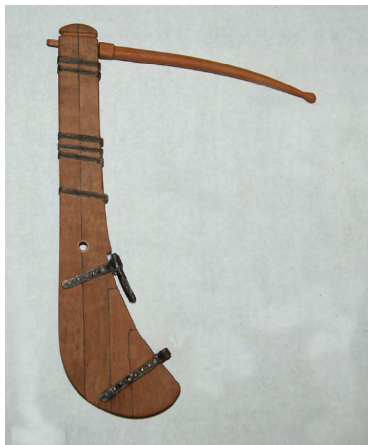
Foto n° 118 - Realizzazione del timone, in testa la barra, vediamo un foro per la braga del timone, sotto l'agugliotto, in fondo la femminella.
