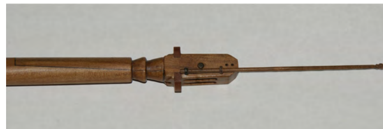
Foto n° 53 - Albero a calcese terminato, con alberetto della freccia inserito nei golfari.
