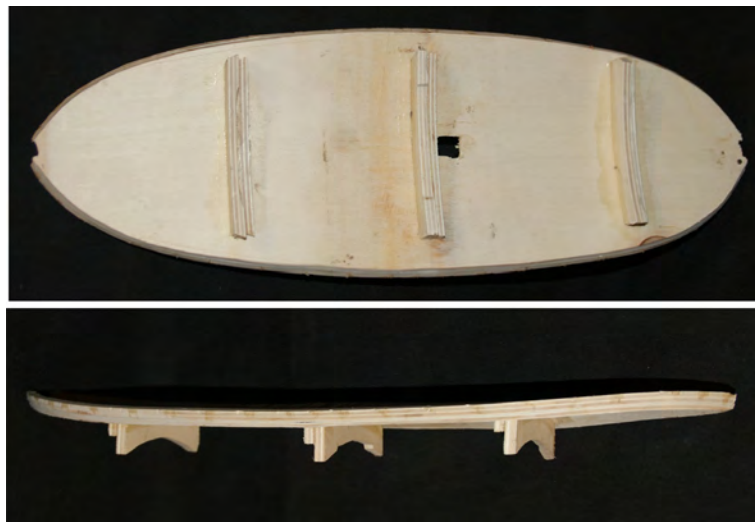
Foto n° 77 - La dima della foto 78 vista da altre prospettive. Per verificare “garantire” le curvature, sono stati inseriti tre supporti con la stessa curvatura del ponte in modo da poter mantenere la distanza esatta per l’applicazione degli scalmotti, il foro quadrato centrale serve per bloccare la dima.
