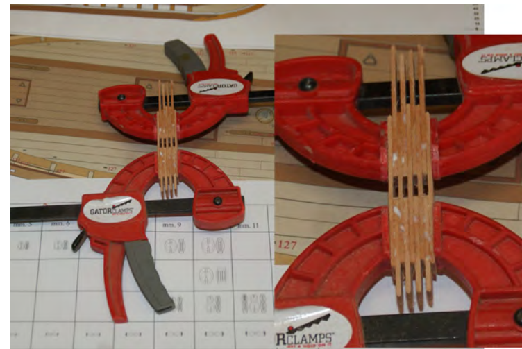
Foto n° 180 - La realizzazione delle taglie e dei taglioni è molto simile. Un modo semplice di fare è incollare tra di loro dei listelli della misura appropriata lasciando vuoti gli spazi in cui saranno inserite le pulegge. Le pulegge sono di legno e in origine erano di olmo.
